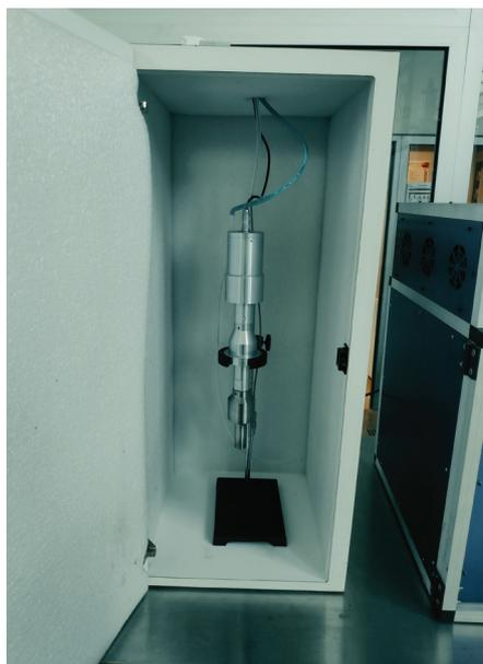
**FIGURA 4.** Sonda de ultrassons de alta intensidade do TAGUSVALLEY, com frequência fixa de 20 kHz e uma potência máxima de 1500W, em *batch* ou em contínuo.
