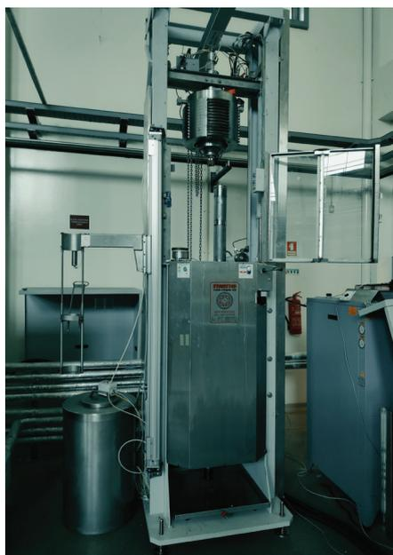
**FIGURA 5.** Equipamento de altas pressões hidroestáticas do TAGUSVALLEY com capacidade de 6 litros por ciclo e pressões até 600 Mpa.
