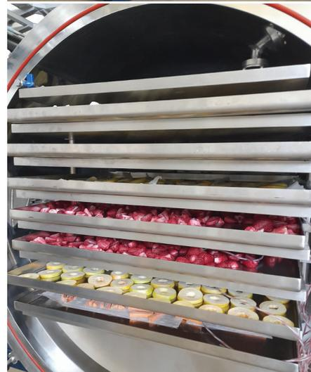
**FIGURA 2.** Liofilizador industrial do TAGUS-VALLEY com capacidade de 130 kg de gelo no condensador por ciclo.
